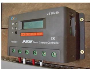
El controlador fotovoltaico trabaja como un regulador de voltaje. La principal función es evitar que la batería sea sobrecargada por el sistema de paneles y protegerla de que se descargue demasiado por las cargas de consumo de corriente directa.
